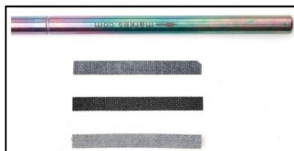
空の TD チューブに TF-SPME を挿入し、加熱脱着装置にセットし、分析します。
