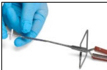
ピンセットを使用して TF-SPME をコッターピンに挟み込みます。
