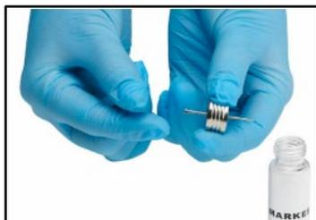
バイアル内でのサンプリング(ヘッドスペースもしくは液体浸漬)を行う場合、バイアルキャップのセプタムにコッターピンを貫通します。
