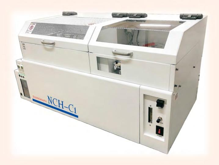
燃焼法(改良デュマ法)・酸素循環燃焼方式
